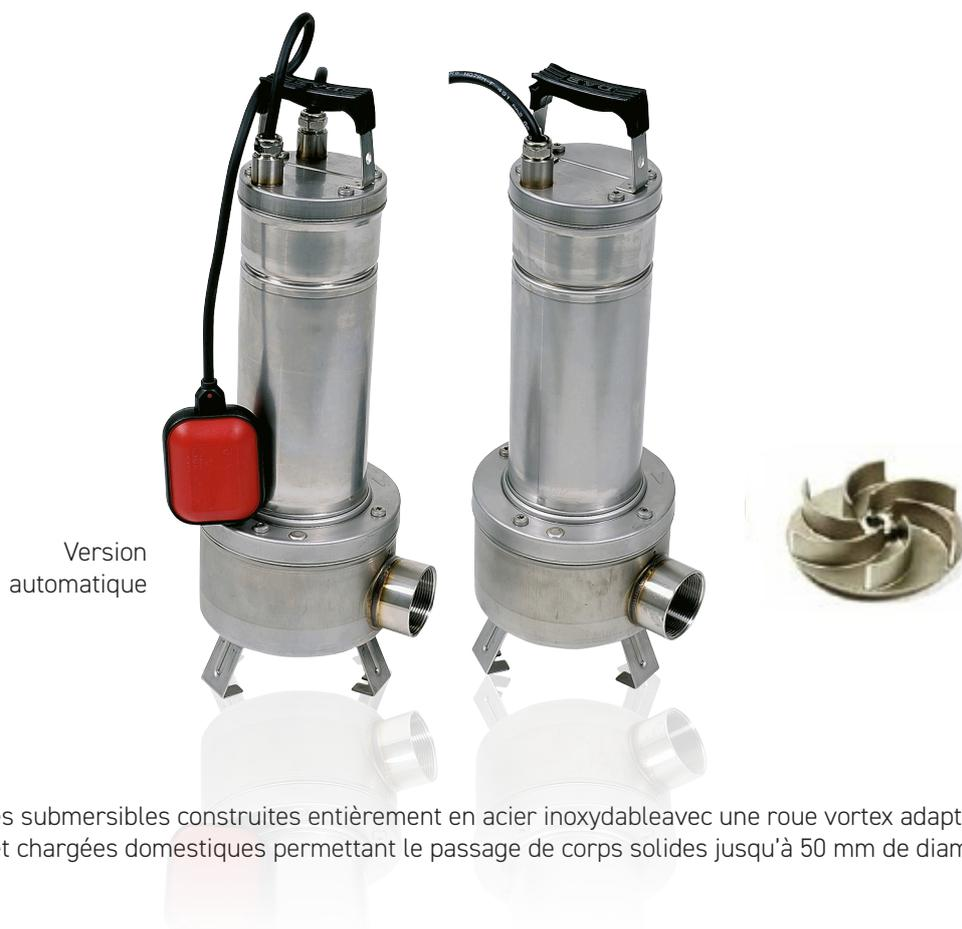
Les FEKA VS sont des pompes submersibles construites entièrement en acier inoxydable avec une roue vortex adaptée au relevage des eaux usées et chargées domestiques permettant le passage de corps solides jusqu'à 50 mm de diamètre.
