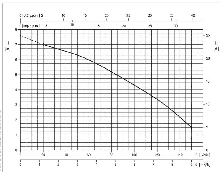
Electropompes submersibles pour eaux claires avec partie hydraulique en acier inoxydable AISI 304.
