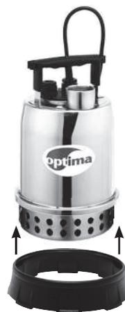
Le dispositif d'aspiration minimale permet de pomper le liquide jusqu'à 3 mm du sol (à partir de 10 mm au moins).
