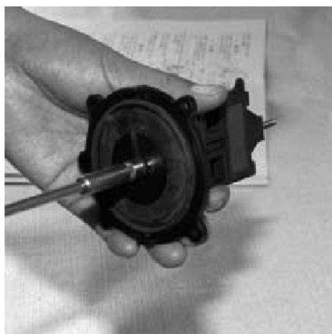
c) Mettre le nouvel aimant avec l'écrou ou la vis.
